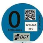
**Etiqueta 0 emisiones, Azul:** Identifica a los vehículos más eficientes. Tendrán derecho a esta etiqueta eléctricos de batería (BEV), eléctricos de autonomía extendida (REEV), eléctricos híbridos enchufables (PHEV) con una autonomía de 40 km o vehículos de pila de combustible.
